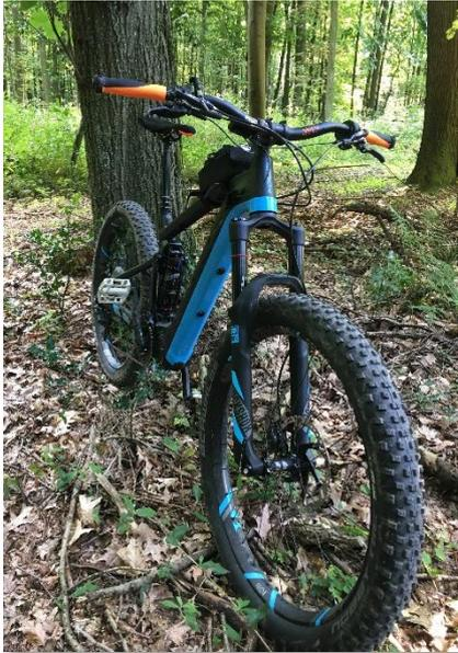
Die Rahmenkonstruktion des Jam<sup>2</sup> weiß auf den ersten Blick zu begeistern. Eine gute Verarbeitung an den Schnittstellen fällt ebenso ins Auge, wie der formschön in das Unterrohr integrierte Akku. Dadurch, dass Focus beim Jam<sup>2</sup> auf eine Pulverbeschichtung verzichtet hat, um es möglichst leicht zu halten, bekommt die Lackierung im Gelände leider recht schnell kleine Macken. Ob man solche als störend empfindet, ist Geschmackssache.
